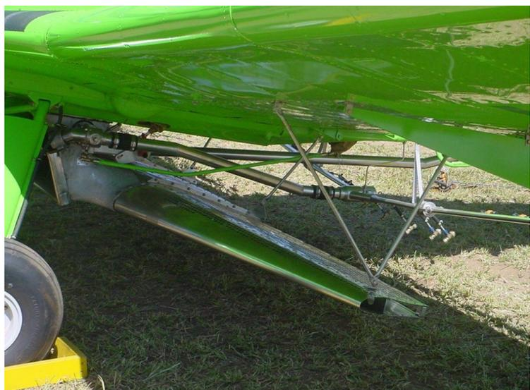
**4.1** - A regulagem baseia-se em angular a parte traseira do “SwathPRO - Difusor de Sólidos – PBA Aviation” em relação ao eixo longitudinal da aeronave, de modo que em voo, ele fique o mais alinhado possível com a direção de voo, ou seja, em voo horizontal com ângulo de ataque zero em relação a linha de voo, permitindo menor arrasto aerodinâmico, maior velocidade da aeronave, maior largura de faixa e menor consumo de combustível.
